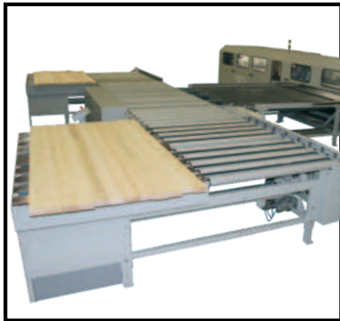
Sortieranlage KS1 für das manuelle Sortieren und Auflegen von Lamellen
