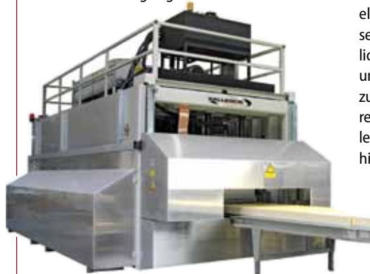
Die Große von Kallesoe Machinery: Der HF-Pressentyp LHF hat sich bei Leimholzherstellern bewährt
